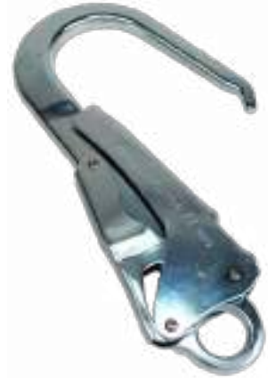
Çelik Kancalı Karabina. . 54 mm ağız açıklığı . Çelik malzeme . Mukavemet 25 kn . 220 mm uzunluk . 2 Emniyetli Otomatik Kilitleme Sistemi
